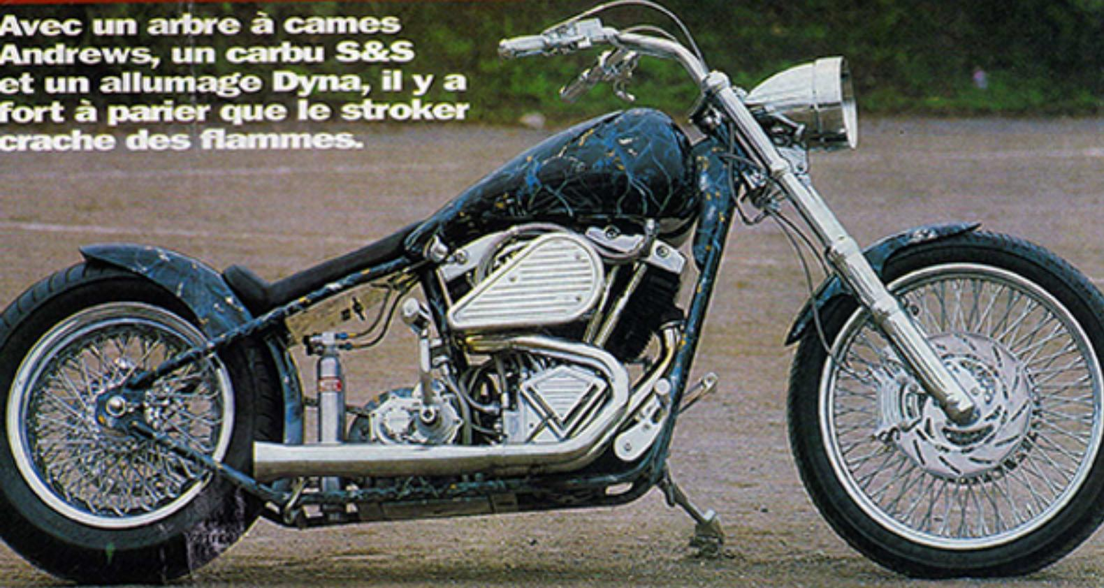
Une fourche rallongée de 2" vient tout naturellement trouver sa place sur la colonne de direction, inclinée de 36°, avant que Charles installe à sa base une jante 80 rayons en 21" flanquée d'un double système de freins à disques Ness. C'est chez ce même fournisseur que Brittany Bike se procure le guidon, les leviers et les poignées. À l'arrière, une jante de 16" rejoint son emplacement en toute simplicité, et sans frein s'il vous plaît... !!!
